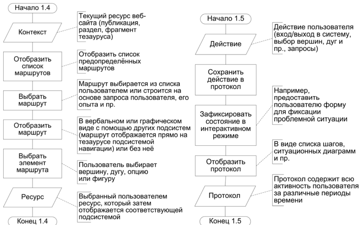
Рис. 7. Схемы работы подсистем маршрутизации и протокольного сопровождения
